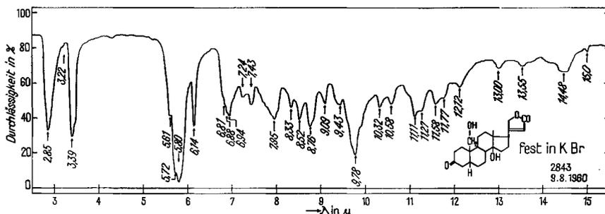
Fig. 9. IR.-Absorptionsspektrum von 19-Hydroxydigitoxigenon (VII)
